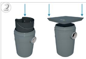
2. Coloque o cesto de limpeza no recipiente e em seguida encaixe a tampa manualmente, empurrando-a até o fechamento total;
