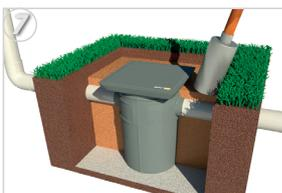
7. Para reaterro local, é importante que o solo em volta da caixa esteja bem compactado, para garantir apoio firme da base da tampa;
