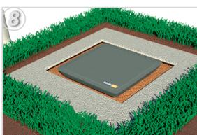
8. Teste a colocação da tampa, executando o acabamento do piso em volta da mesma para evitar deformação lateral.
