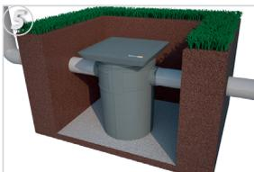
5. Instale o produto sobre base nivelada. Se a instalação for realizada sobre areia, é importante que a areia esteja bem compactada. Se o nível do lençol de água for muito elevado, deve ser efetuada drenagem antes da instalação;
