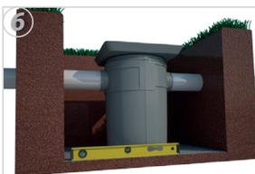
6. O assentamento da base da caixa deve ocorrer no fundo da vala da rede de esgoto, previamente preparada e nivelada;
